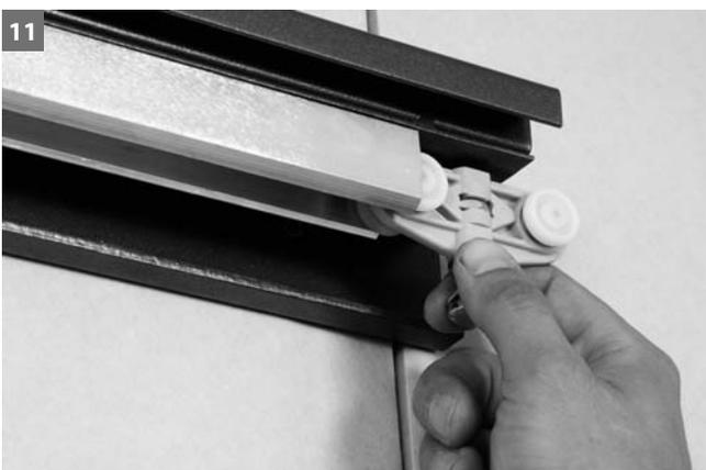
11 2 Laufwagen einschieben und Endanschlag mit Auflaufdämpfung montieren. Anschließend zweiten Endanschlag vormontieren
