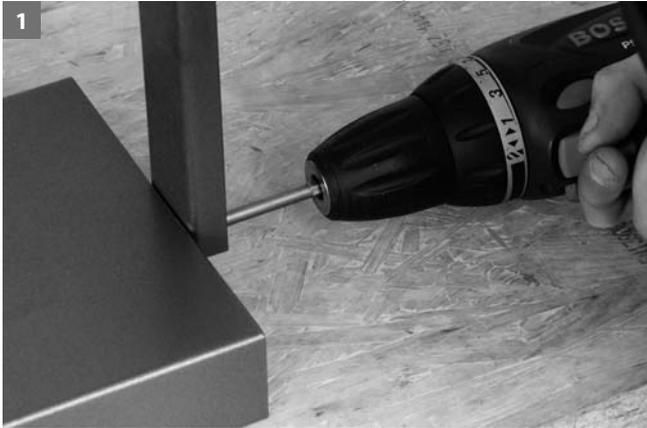
Der Transportwinkel muss vor dem Einbau in Ständerwand entfernt werden.
