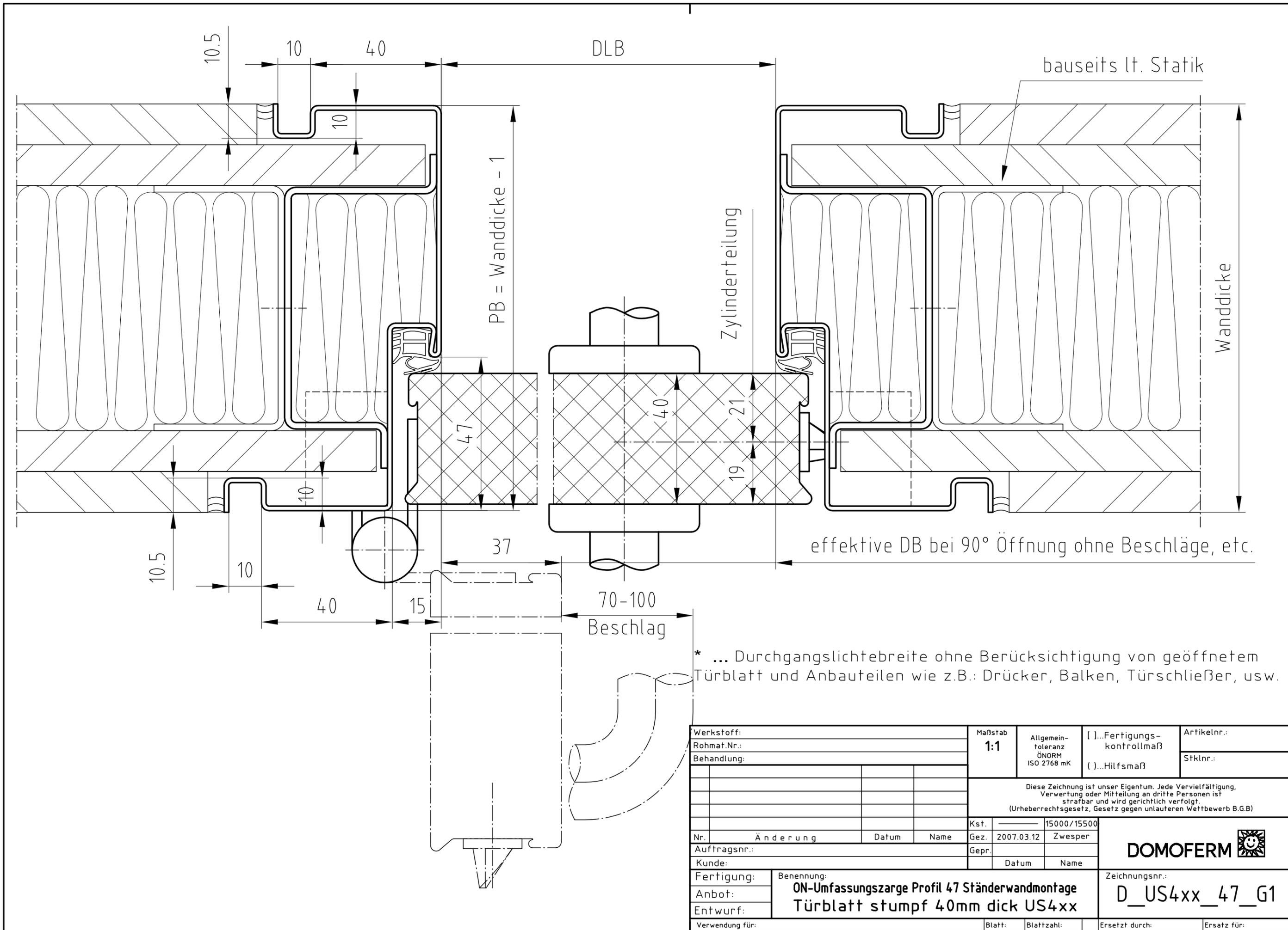
\* ... Durchgangslichtbreite ohne Berücksichtigung von geöffnetem Türblatt und Anbauteilen wie z.B.: Drücker, Balken, Türschließer, usw.
