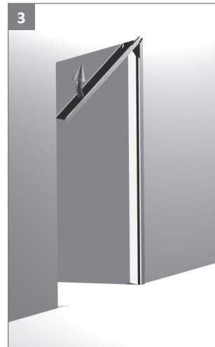
3 Zargenquerteil in Langteil einhängen und in horizontale Position schwenken
