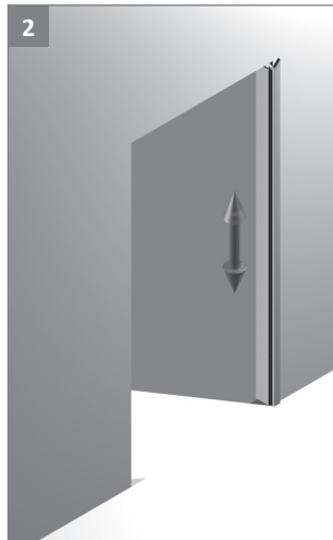
2 Zargenlangteil vertikal einrichten
