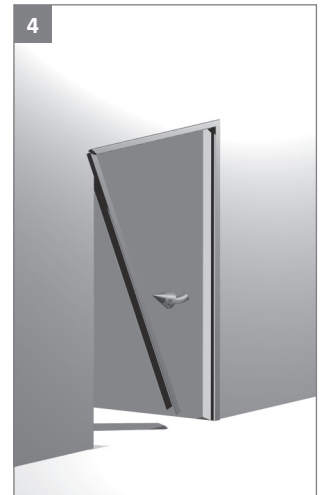
4 Zweiten Zargenlangteil in den Querteil einschwenken
