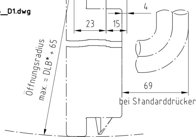
\* ... Durchgangslichtbreite ohne Berücksichtigung von geöffnetem Türblatt und Anbauteilen wie z.B.: Drücker, Balken, Türschließer, usw.
