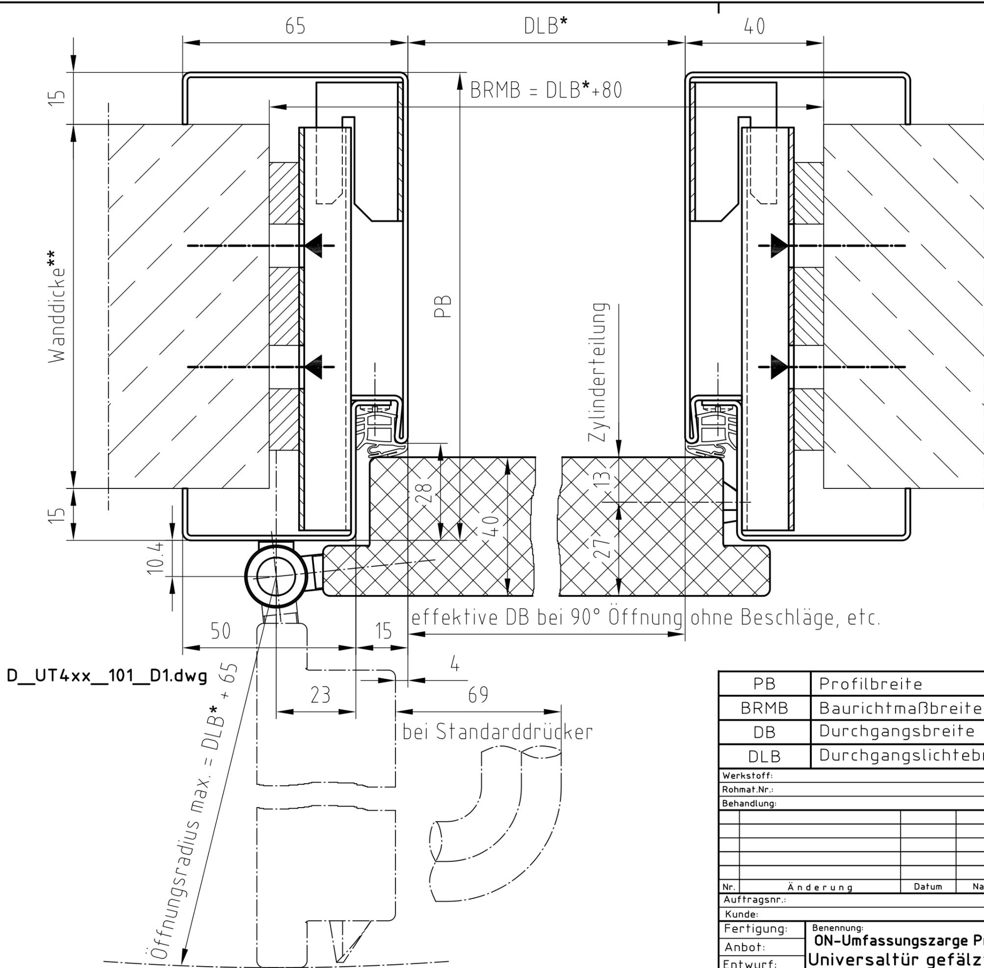
\*\* ... Aufgrund der 2-fachen Befestigung empfehlen wir eine Mindestwanddicke von 105mm.
