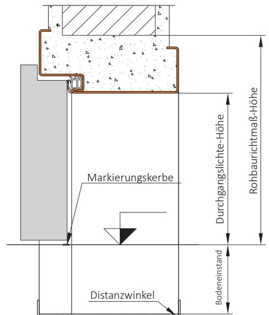
**WICHTIG:** Vor dem Einbau ist die Maueröffnung in Hinblick auf Rohbaurichtmaß und Wandbeschaffenheit und die Zarge in Hinblick auf Einbauteile wie Maueranker, Dübelvorrichtungen, Schutzkästen, Bandunterkonstruktionen und allfällige elektrische Anschlussmodule zu prüfen. Notwendige Ausnehmungen im Mauerwerk bzw. gesonderte Abdichtungen bei der Hinterfüllung mit dünnflüssigem Mörtel sind vorzusehen.
