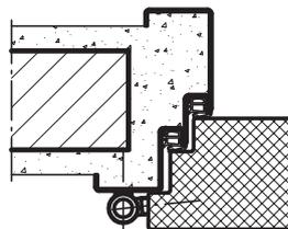
Standardausführung Doppelfalzzarge für Mauermontage M
