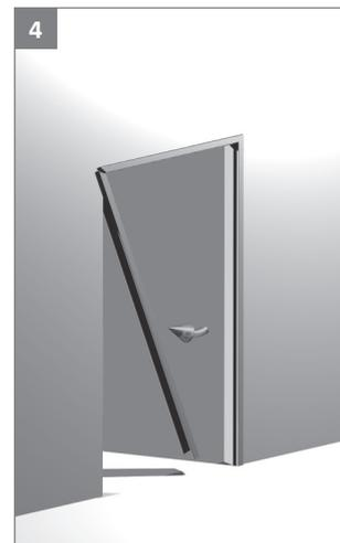
Zweiten Zargenlangteil in den Querteil einschwenken.
