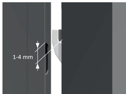
Einstellung des Schwenkriegelschlosses (wenn vorhanden) über die Bandhöhenverstellung möglich.
