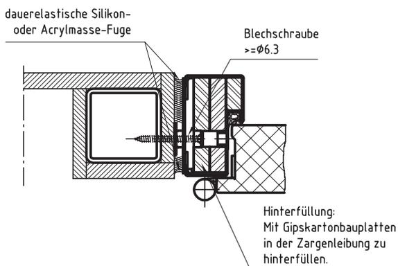
**In feuerschutztechnisch geprüfte mindestens feuerbeständige Panelwände**
