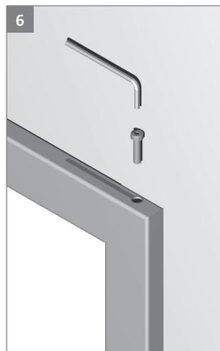
Lage und Winkeligkeit der Zarge überprüfen - Gehrung mit beiliegenden Inbusschrauben verschrauben.
