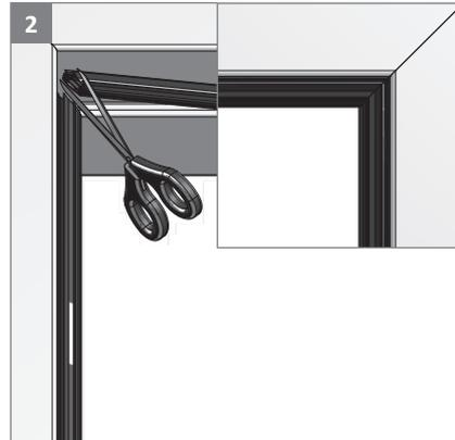
Dichtung in den Kopfteil einlegen, abschnittsweise eindrücken, dabei mit dem Daumen gegen die Einlegerichtung streichen, Dichtung in Gehrung (wahlweise stumpf) ablängen.
