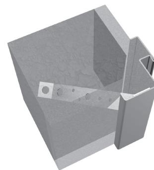
█ Positionsbereich Maueranker +/- 50 mm
