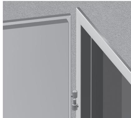
Abb. 9.1.5.3 Türblatt eingehängen
