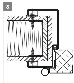
Querteil horizontal, Langteile lotrecht und parallel ausrichten, Falzmaße von oben nach unten kontrollieren. Zarge durch vorhandene Bohrungen (5 Stück je Seite) mit Schnellbauschrauben (Zubehör) befestigen.
