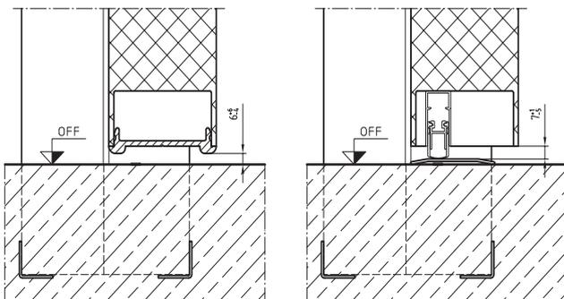
Das Türblatt kann nach Demontage des Alu-Abschlussprofils um bis zu 15 mm gekürzt werden.
