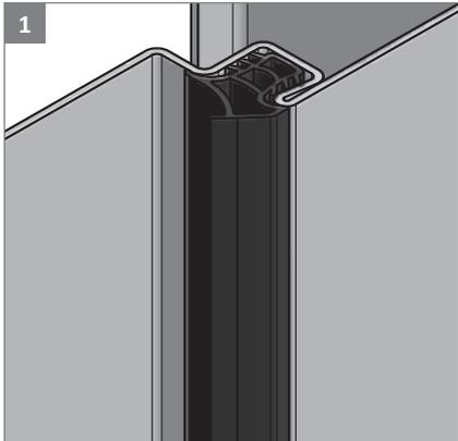
Auf die richtige Lage der Dichtung in der gereinigten Dichtungsnut achten! Eine Längendehnung der Dichtung muss vermieden werden.
