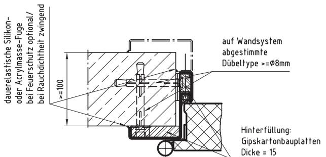
An mindestens feuerbeständig ummantelten Stahlbauteilen
