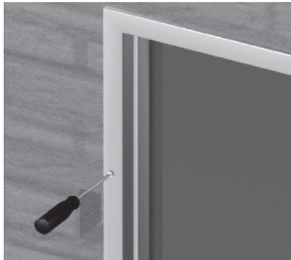
Abb. 9.1.5.1 Verschlusskappen entfernen
