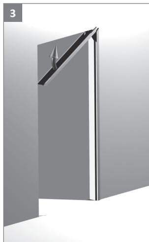
Zargenquerteil in Langteil einhängen und in horizontale Position schwenken.
