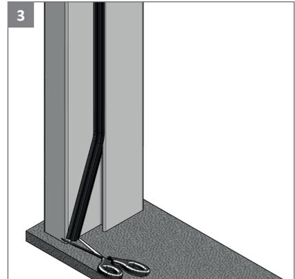
Dichtung in die senkrechten Zargenteile von oben nach unten einlegen, abschnittsweise eindrücken, dabei mit den Daumen gegen die Einlegerichtung streichen, Dichtung ablängen (bei allseitig umlaufender Dichtung auch unten)
