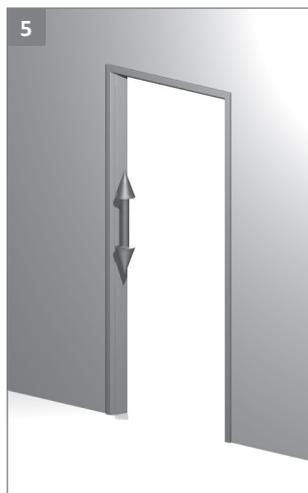
Zargenlangteil vertikal ausrichten.
