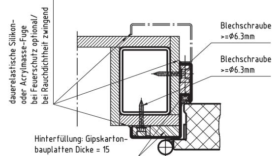
In feuerschutztechnisch geprüfte mindestens feuerbeständige Paneelwände
