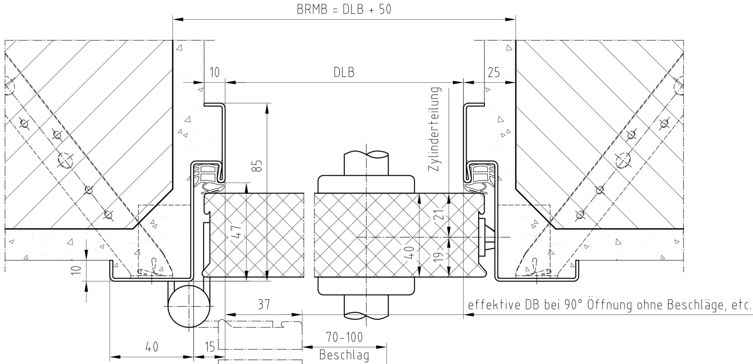
\* ... Durchgangslichtbreite ohne Berücksichtigung von geöffnetem Türblatt und Anbauteilen wie z.B.: Drücker, Balken, Türschließer, usw.
