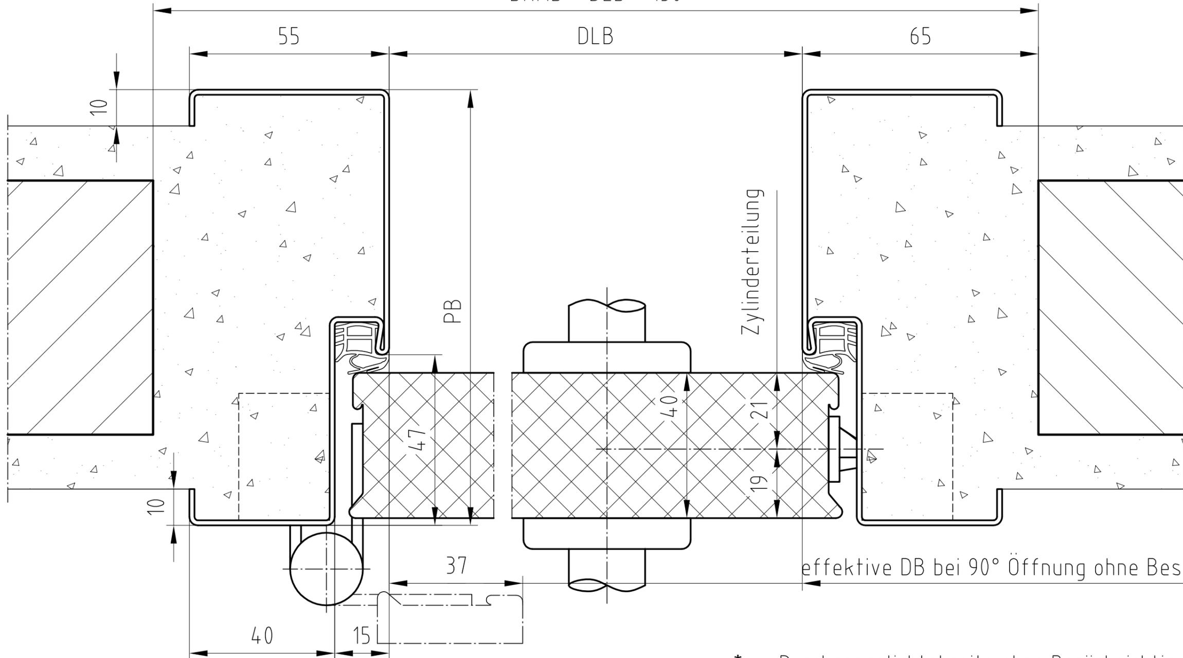
effektive DB bei 90° Öffnung ohne Beschläge, etc.
