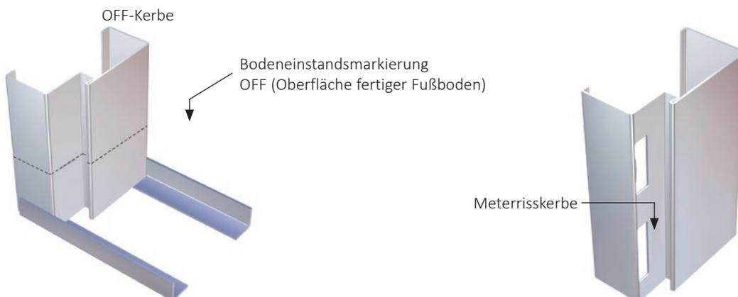
Die Zarge ist nach dem Meterriss bzw. der Bodeneinstandsmarkierung (OFF-Kerbe) auszurichten und festzusetzen
